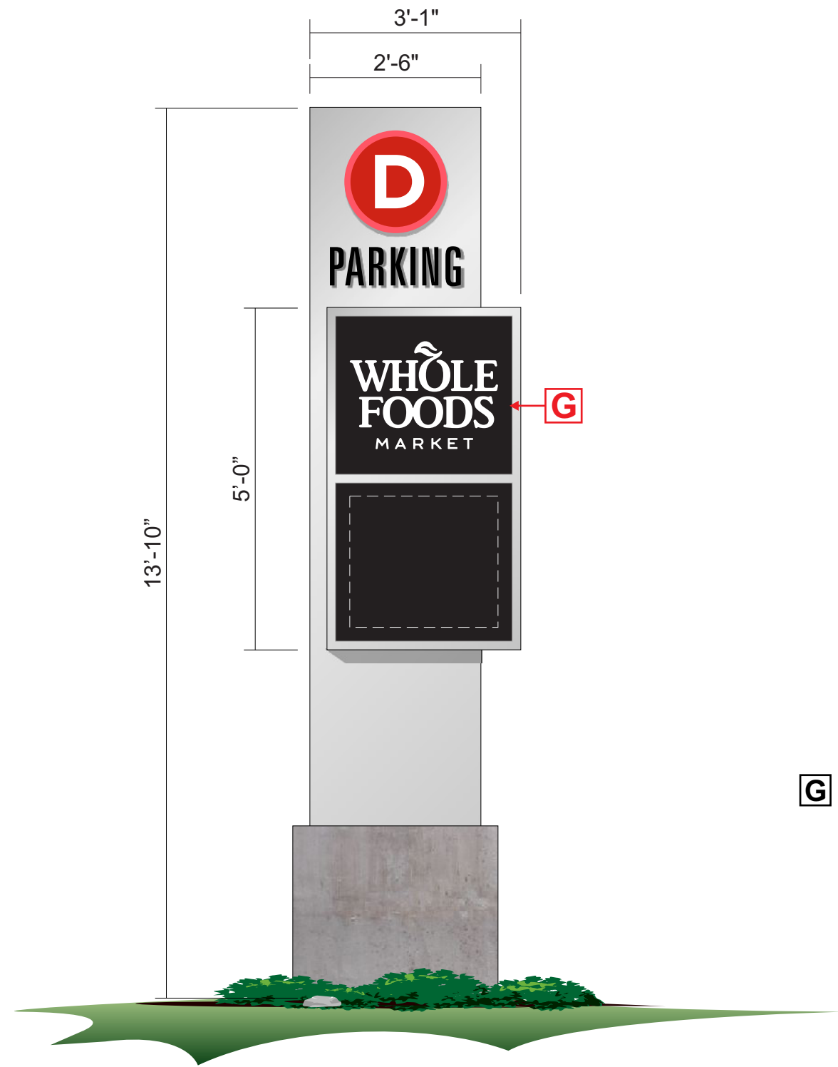
Pylon Elevation - Scale: 1/2" = 1'-0"
