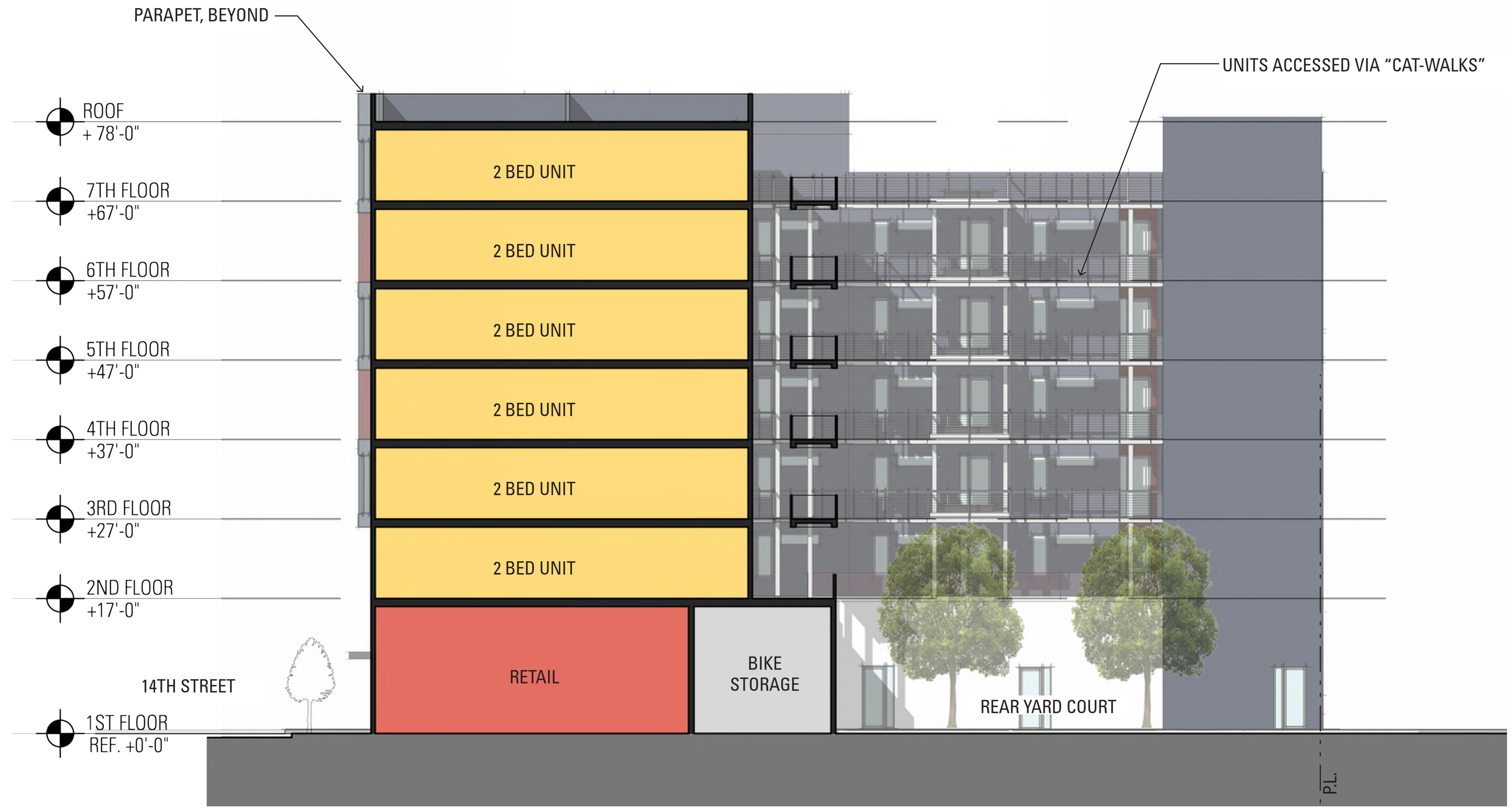
LONGITUDINAL SECTION - A
